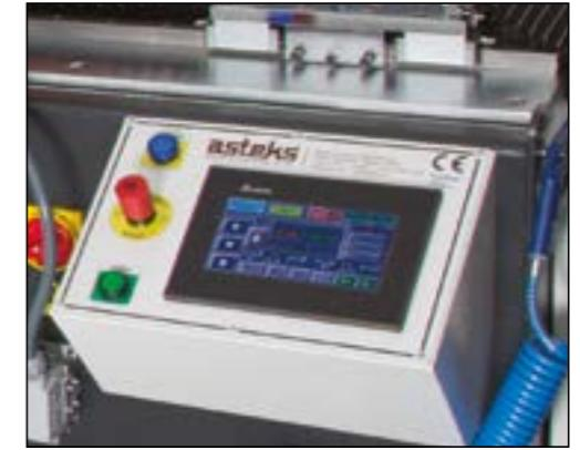
Dokunmatik Ekran Kontrol Paneli
